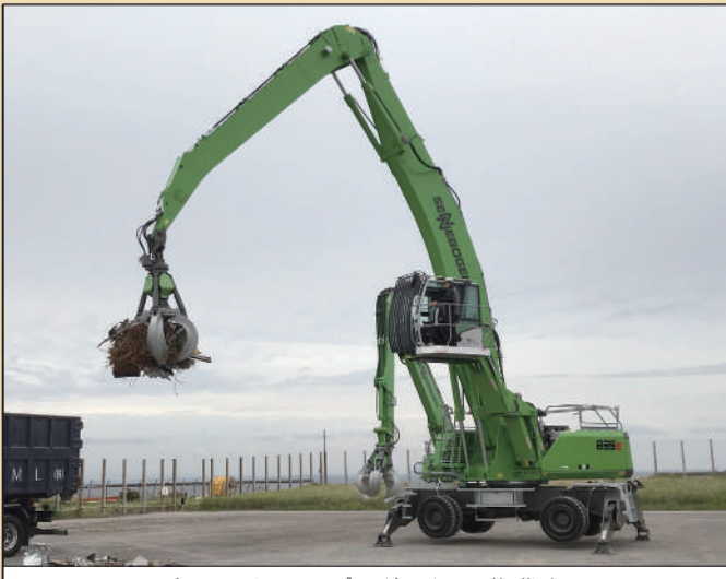
金属スクラップの積み込み作業を実演したマテハン機「835E」
