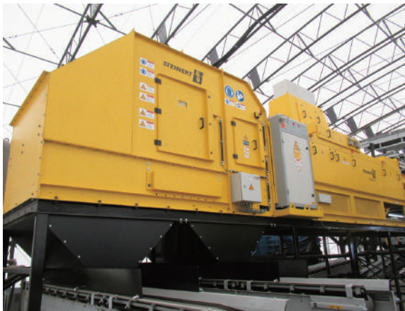
4種のセンサー(透過X線・金属・カラー・3D)を搭載した「K S S コンビネーションソーター」
