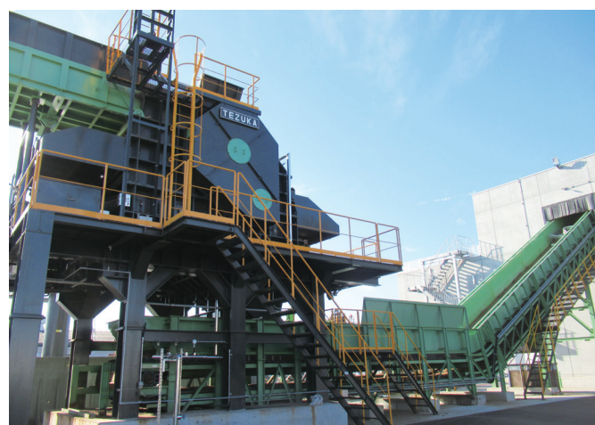
「300Hシュレッダー」で粗破碎してコンベアに流す
